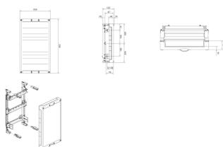
**Kit, univers N, 450x250mm, pour bornes sur rail DIN horizontal, rail DIN ajustable**
