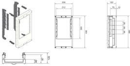
**Baustein, universN, 450x250mm, für 1 Trenner NH2 auf Sammelschienensystem 60mm**
