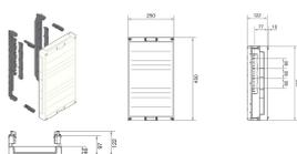
**Baustein, universN, 450x250mm, für Sammelschienensystem 60mm, 4 polig, waager.**
