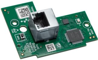
**Erw.-karte für witty start z. Einbindung in Energiemanagement Controller flow R2**
