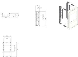
**Baustein, universN, 450x250mm, für 2 Trenner NH00 auf Sammelschienensystem 60mm**
