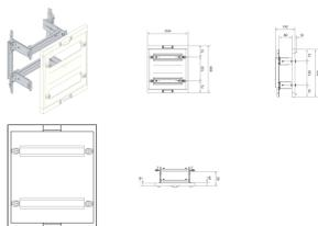
**Baustein, universN, 300x250mm, für Reihenklemmen waag., verstellbare Hutsch.**
